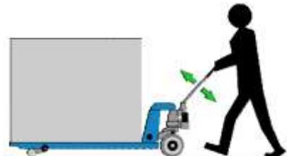
Груз поднимается при движении ручки гидравлической тележки.
